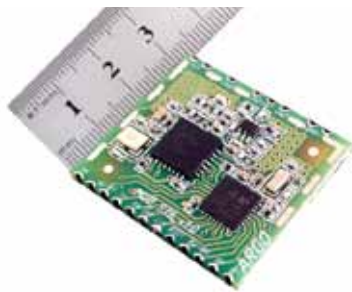
Рис. 7. Встраиваемый LoRa-модуль от НТЦ «АРГО»
