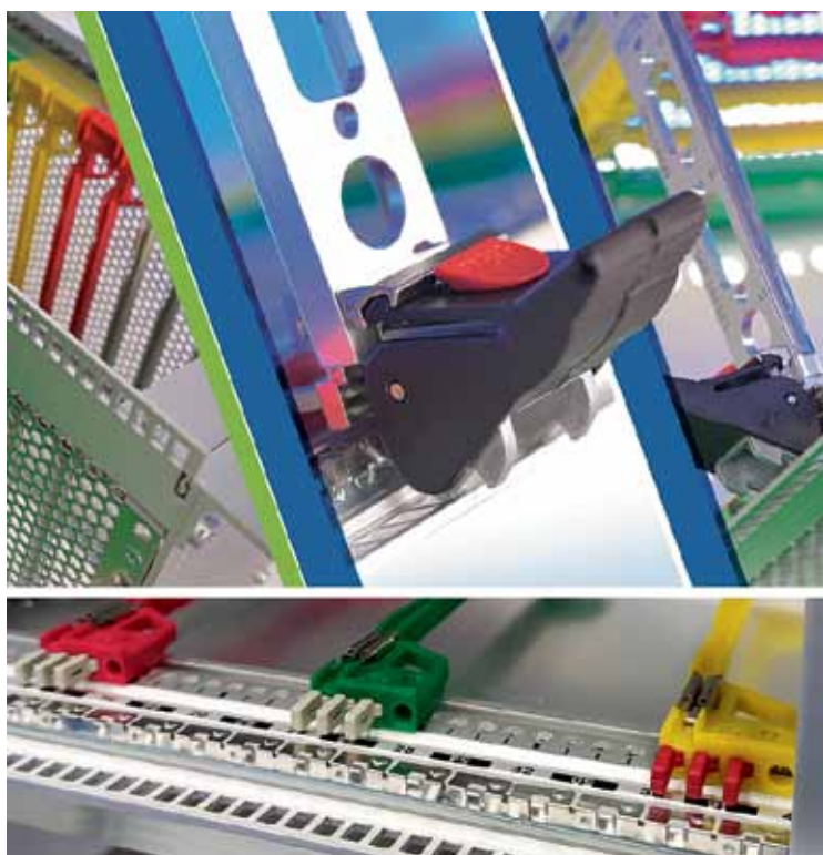
Рис. 2. Решения HEITEC для работы с электронными модулями: сверху – установочно-выталкивающая ручка типа IVs с металлической вставкой обеспечивает надежное обслуживание модулей при нагрузке более 800 Н; снизу – цветное и механическое кодирование направляющих для карт предотвращает ошибку при обслуживании электронных модулей
