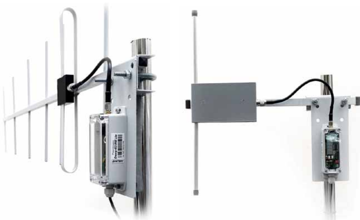
▲ Рис. 4. Примеры монтажных комплектов «антенна + фидер + модем»
