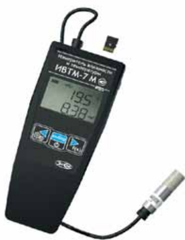
Рис. 2. Переносной термогигрометр ИВТМ-7 М 6-Д-1
