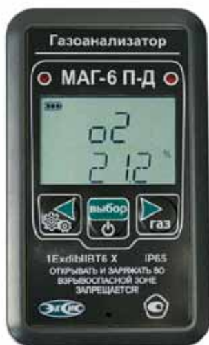
Рис. 6. Портативный газоанализатор МАГ-6 П-Д
