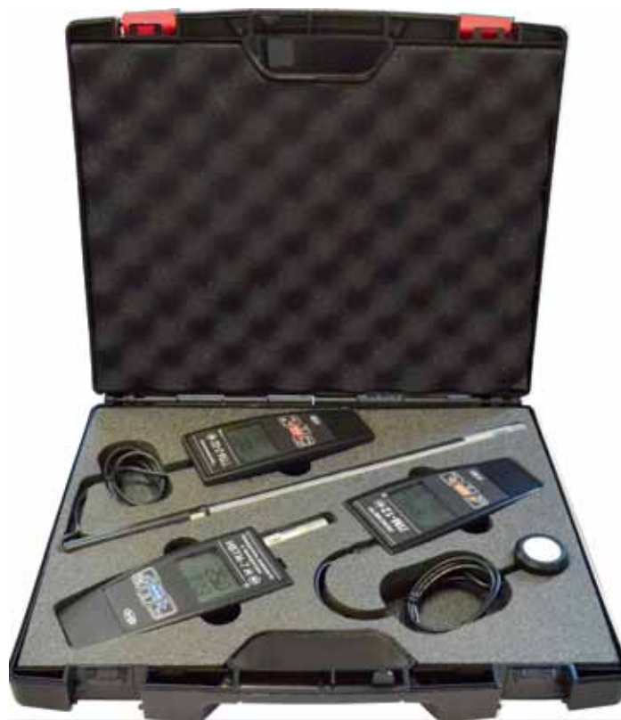
Рис. 1. Комплект приборов для контроля параметров микроклимата «Базовый»
