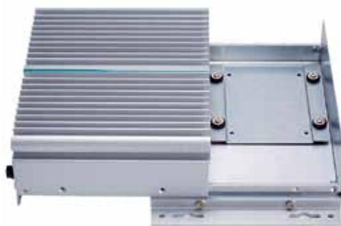
▲ Верхняя часть корпуса UST100-504 сдвигается, открывая доступ к накопителю SATA
