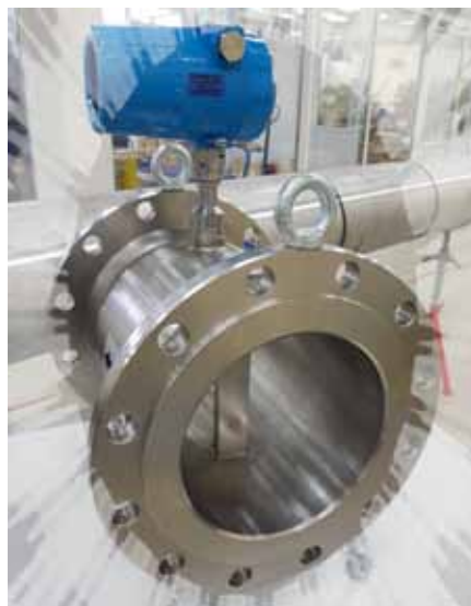
Рис. 1. Вихревой датчик расхода газа пара, жидкостей «Дайметик-1261»
