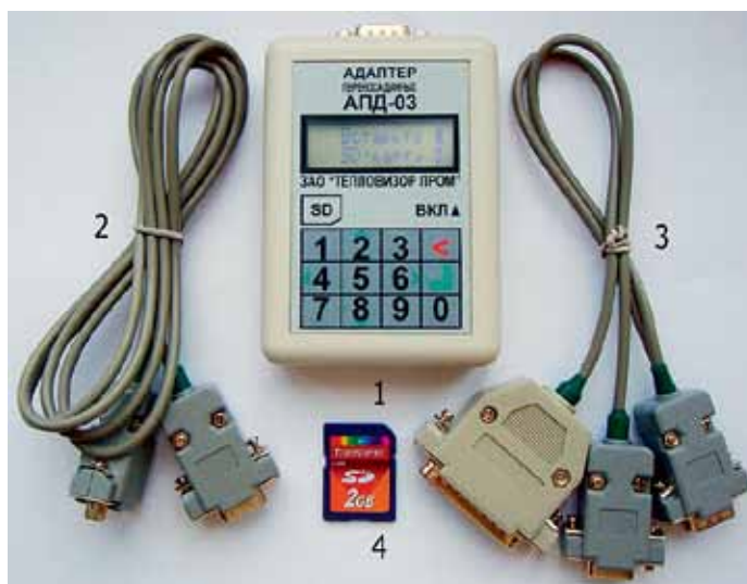
Рис. 1. Адаптер переноса данных АПД-03 (комплект): 1 — АПД-03; 2 и 3 — коммуникационные кабели; 4 — SD-карта
