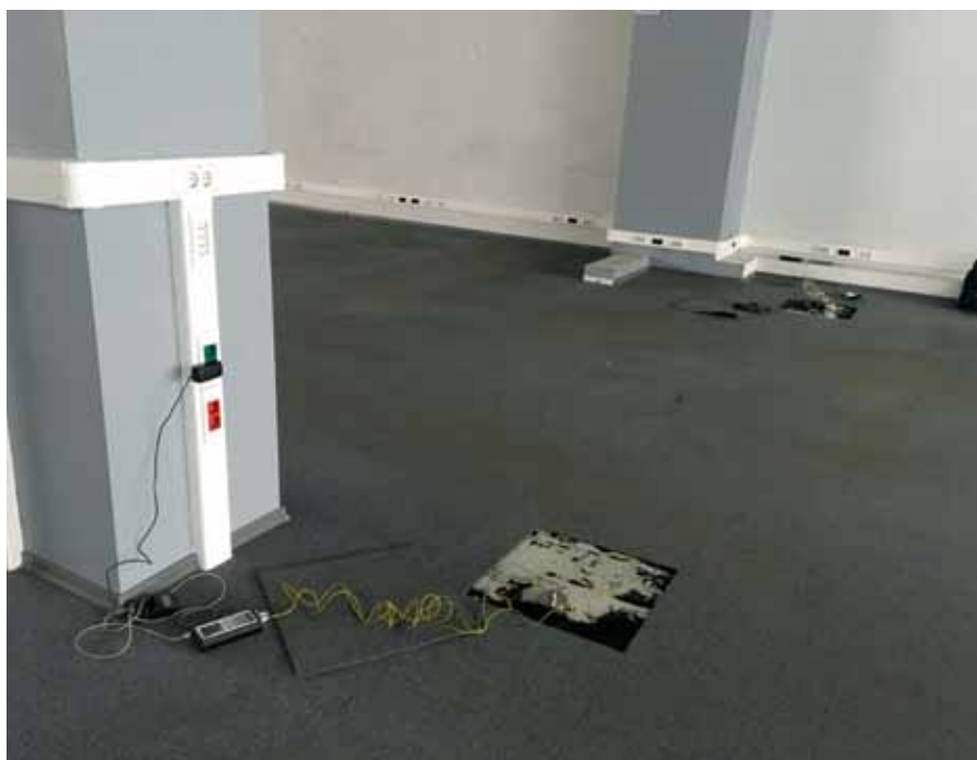
Рис. 4. Прибор «Экофизика-110А» в режиме мониторинговых измерений вибрации
