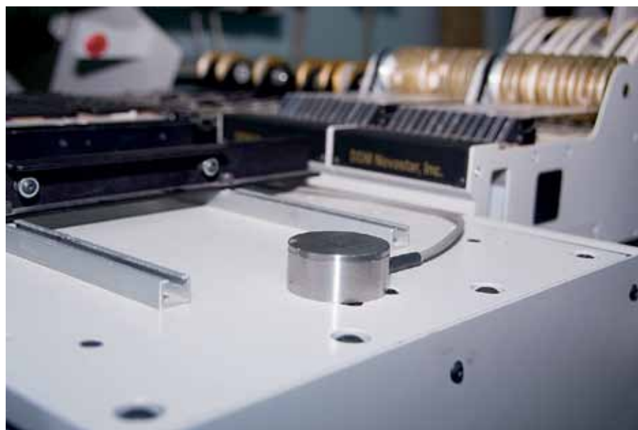
Рис. 1. Мониторинг уровня вибрации на промышленных станках с помощью ZET 7152-N Pro
