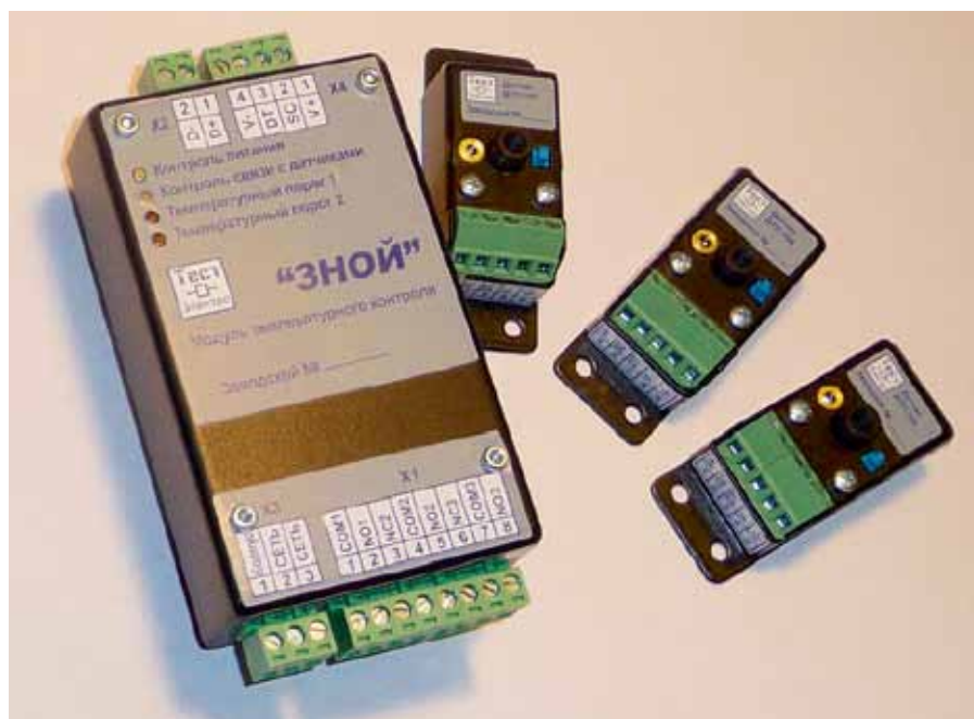
Рис. 1. Компоненты системы «Зной»: модуль температурного контроля и пирометрические датчики ДТП-300
