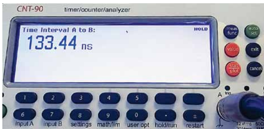
Рис. 4. Тестирование сети сравнением сигналов PPS
