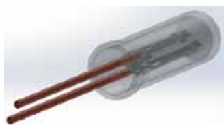
Рис. 1. Пьезоэлемент камертонного типа
