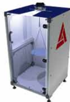
Модуль №2 с системой подвеса и эталонными гирями для поверки буйковых уровнемеров.
