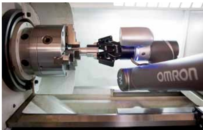
Рис. 9. Применение коллаборативного робота OMRON для работы на токарном станке
