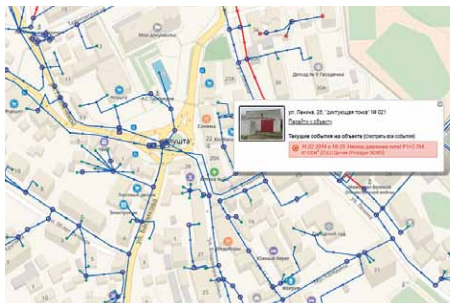
Рис. 7. Интерактивный анимированный веб-интерфейс облачной системы диспетчерского контроля ZuluGIS
