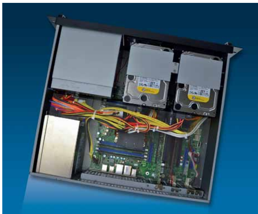
Рис. 2. Промышленные компьютеры в 19-дюймовую стойку предоставляют достаточно места для индивидуальной конфигурации (вид сверху)
