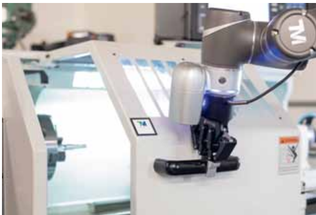
Рис. 3. Модуль технического зрения на манипуляторе
