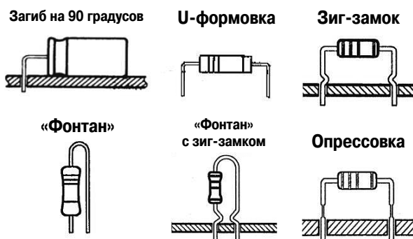
Рис. 7. Виды формовки выводов
