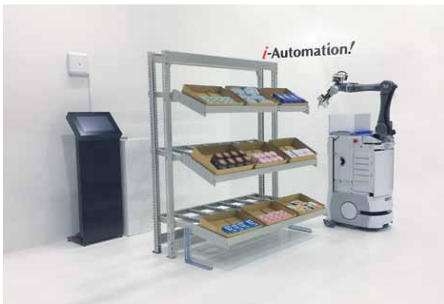
Рис. 10. Коллаборативный робот OMRON, установленный на мобильном роботе, работает на складе
