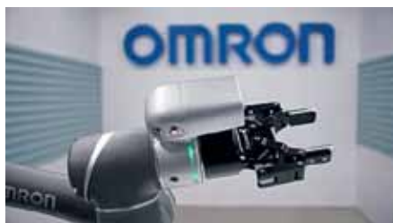
Рис. 6. Один из захватов коллаборативного робота OMRON
