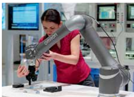
Рис. 5. Ручное управление захватом
