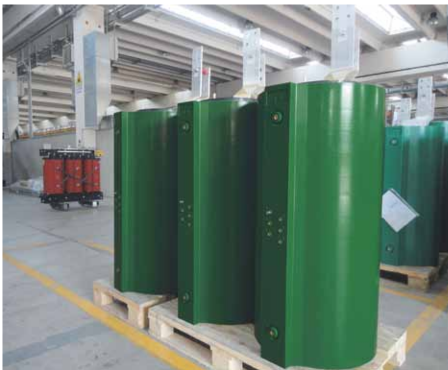
Рис. 3. Сухие трансформаторы Zucchini Legrand в процессе производства
