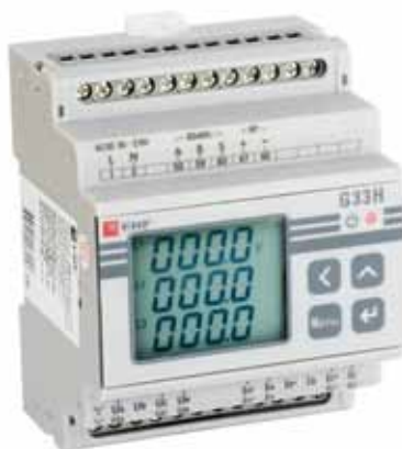
Рис. 2. Измерительный прибор EKF G33H
