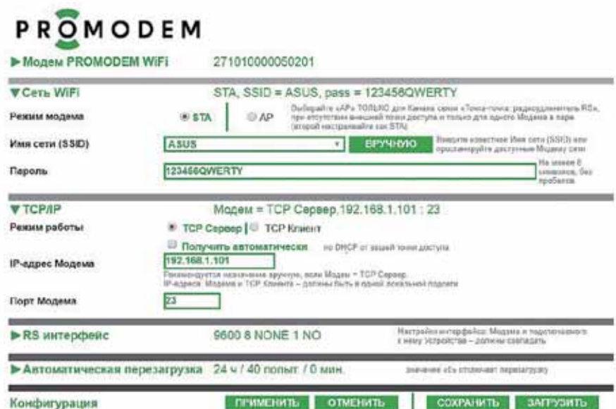
Рис. 5. Модем PROMODEM Wi-Fi с веб-интерфейсом настройки через браузер
