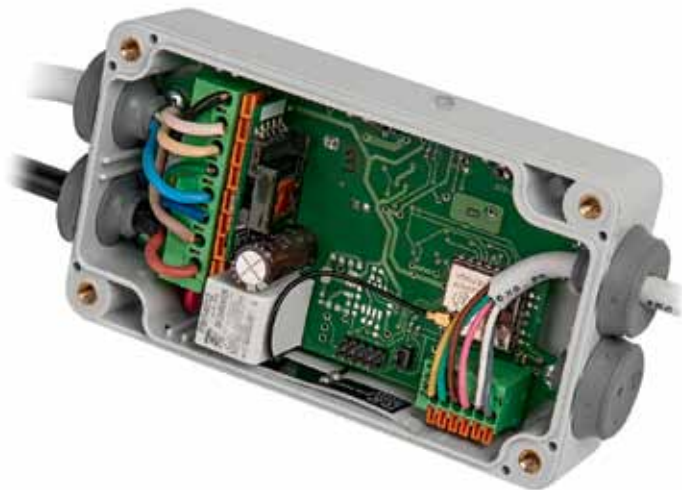
Рис. 6. Контроллер LED PROMODEM Wi-Fi для плавного управления яркостью светодиодного светильника и опроса датчиков
