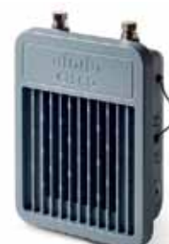
Рис. 3. Внешний вид некоторых базовых станций LoRaWAN
