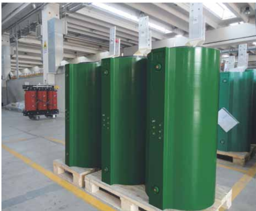
Рис. 3. Сухие трансформаторы Zucchini Legrand в процессе производства
