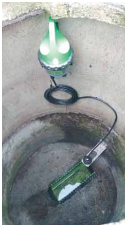
Рис. 2. Расходомер LT-US, установленный на объекте
