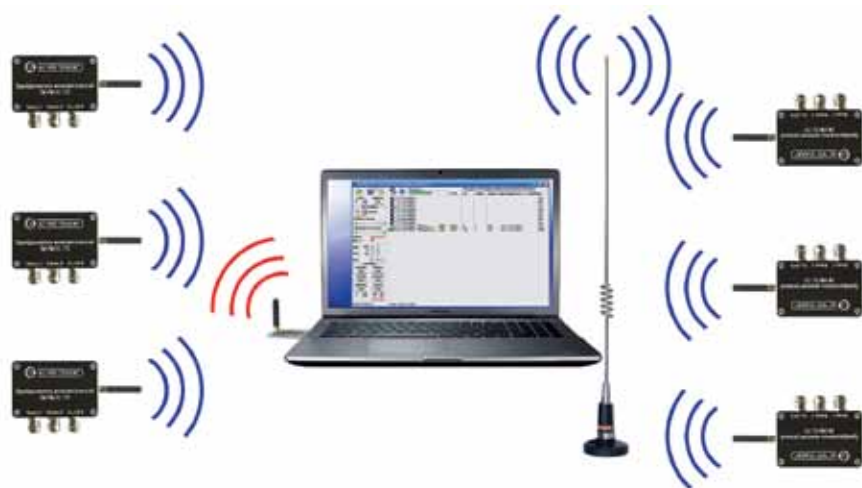
Рис. 3. Беспроводная сеть ПИ РМ
