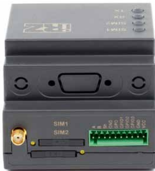
Рис. 2. Беспроводной модем iRZ ATM31: антенный разъем, слоты для двух сим-карт, разъем для подключения интерфейсов и питания
