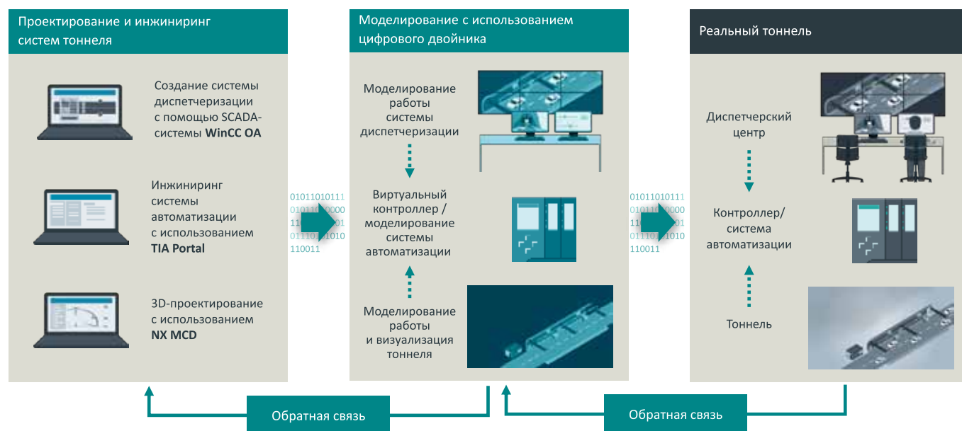
Рис. 7. Цифровая цепочка создания систем автоматизации и диспетчеризации тоннеля
