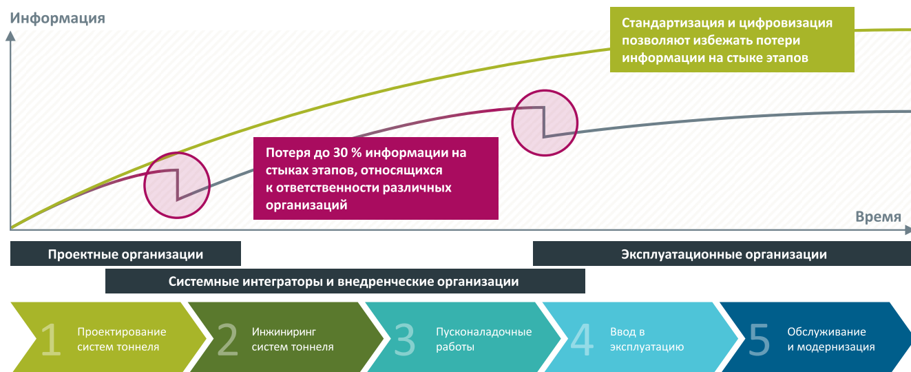
Рис. 6. Оптимизация процесса использования информации на протяжении жизненного цикла тоннельного объекта
