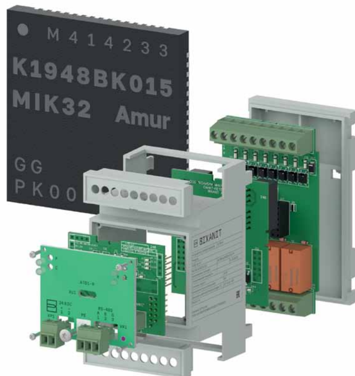
Рис. 1. Модуль ввода/вывода ATD1-R в разобранном виде и микроконтроллер МІК32 Амур
