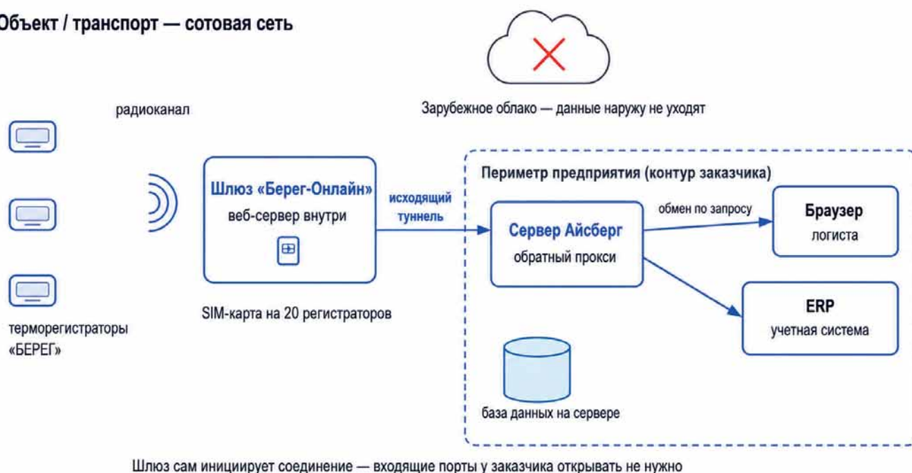
Рис. 2. Архитектура комплекса «Берег-Онлайн»: вычисления и данные остаются внутри периметра предприятия
