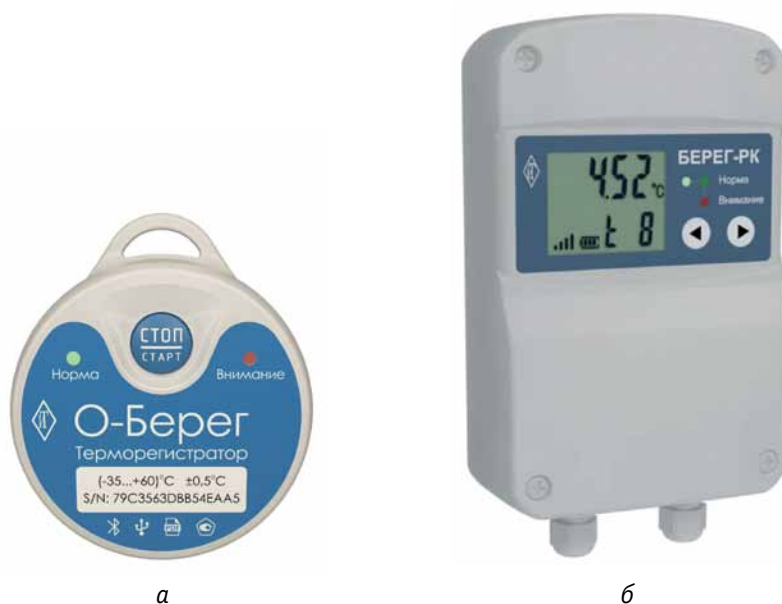
Рис. 3. Два класса приборов под разные участки холодовой цепи: а — моноблок-шайба «Берег-ТО» («О-Берег») для стандартного режима; б — защищенный стационарный «Берег-РК» с ЖК-дисплеем и герметичными вводами для криосреды и чистых помещений
