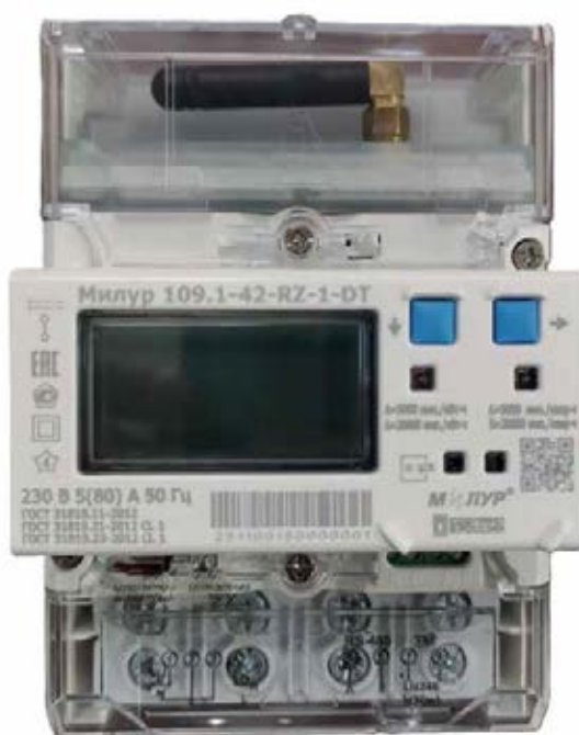
Рис. 1. Интеллектуальный счетчик электроэнергии «МИЛУР 109» со сменным модулем, размещенным в пломбируемом отсеке
