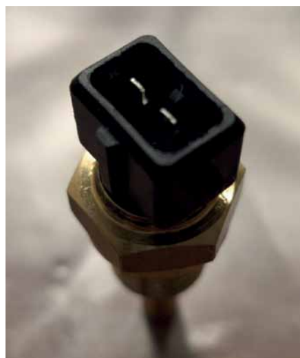
Рис. 3. Датчик температуры ЧЭПТ-3-БР: встроенный автомобильный разъем стандарта DIN 46244 (AMP JPT 106462-1)
