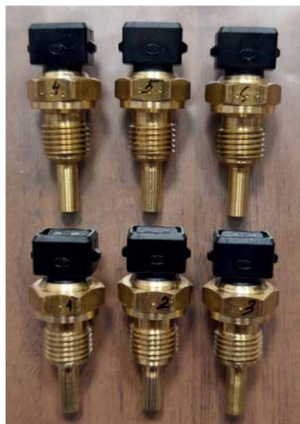
Рис. 1. Датчики температуры жидкости ЧЭПТ-3-БР для карьерной техники «БЕЛАЗ»
