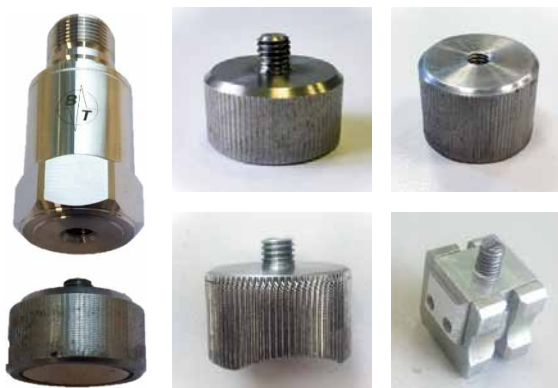
Рис. 5. Магнитные адаптеры для установки вибродатчиков
