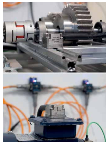
Рис. 2. Примеры установки вибродатчика ZET 139
