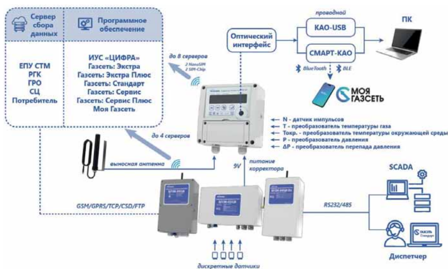
Рис. 4. Интерфейсы подключения и информационные потоки ПК-ТМ
