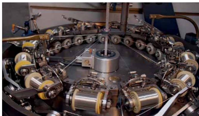
Рис. 1. Производство саморегулирующегося кабеля на заводе в г. Дедовске
