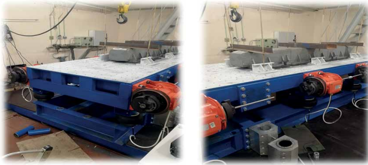
Рис. 1. Электромеханический вибростенд серии ВЭМ повышенной мощности
