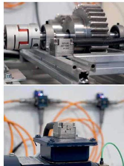
Рис. 2. Примеры установки вибродатчика ZET 139
