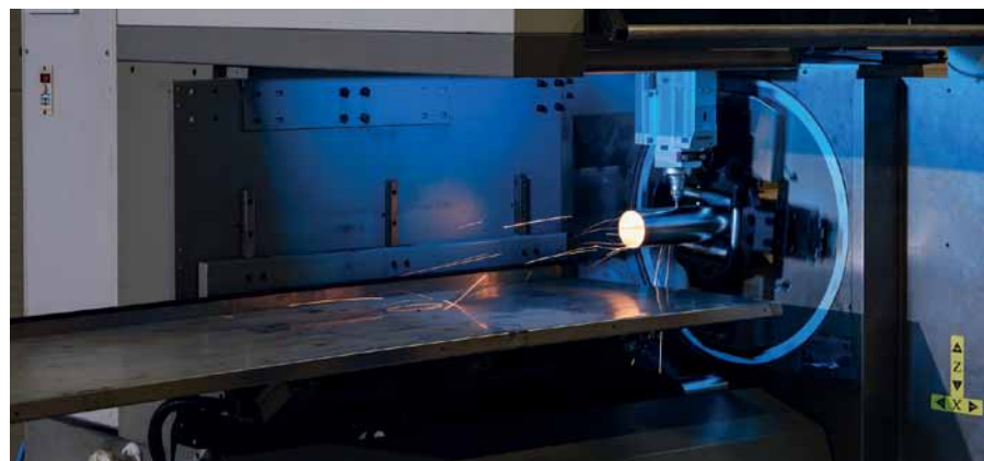
Рис. 2. Обрезка коллектора для установки повышения давления на производстве
