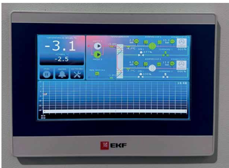
Рис. 3. Автоматизация производства напитков: визуализация на экране панели оператора EKF PRO-Screen
