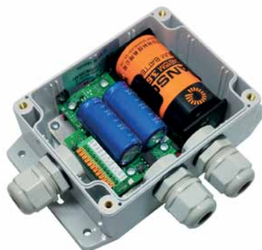
Рис. 4. Регистратор гидроударов серии PROMODEM PRO с автономным или внешним питанием
