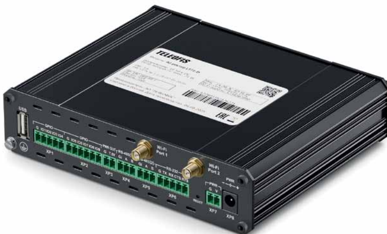
Рис. 1. 4G/Wi-Fi-роутер TELEOFIS LT71-GD: а — вид спереди; б — вид сзади
