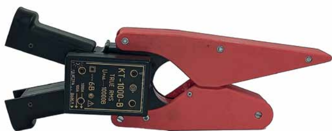
Рис. 4. Специальная накладка на губки клещей, позволившая расширить сферу применения КТ-1000-В
