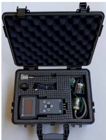
Рис. 2. Компоненты портативного газоанализатора ДАГ-600 в кейсе
