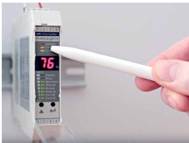
Рис. 3. Пример работы индикатора «Сигнализация» у преобразователя НПСИ-ДНТН
