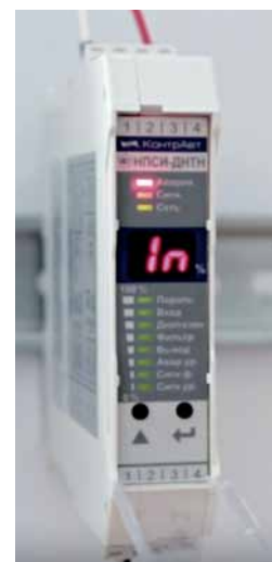
Рис. 10. Пример индикации аварийной ситуации у нормирующего преобразователя НПСИ-ДНТВ
