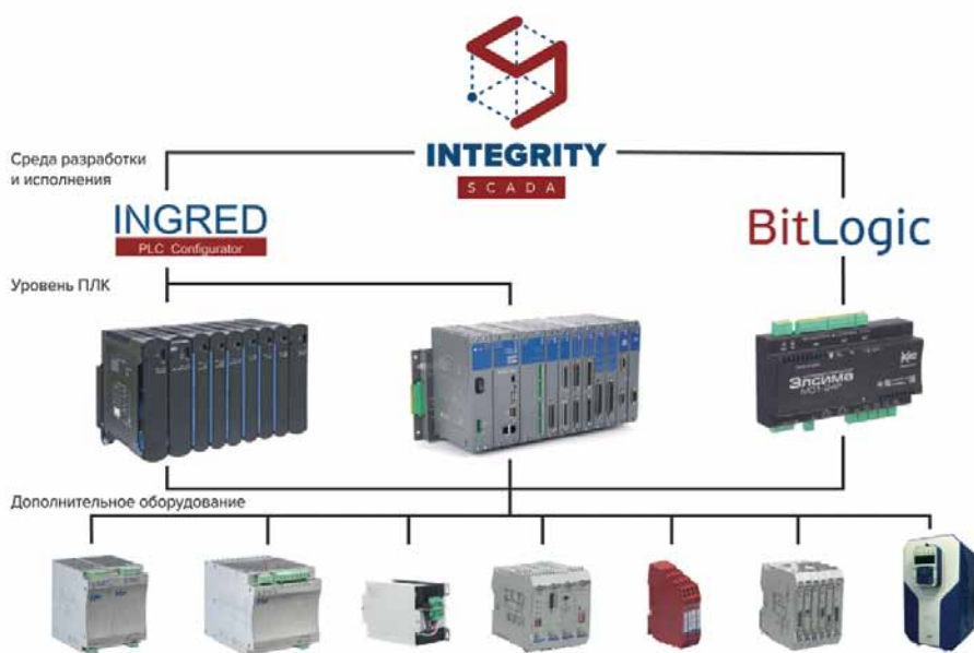
Рис. 3. Схема построения индивидуального ПАК на базе элементов, входящих в экосистему «ЭлеСи»
