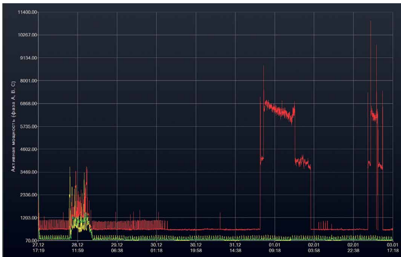
Рис. 2. Фиксация значений активной мощности по фазам в режиме «Самописец»
