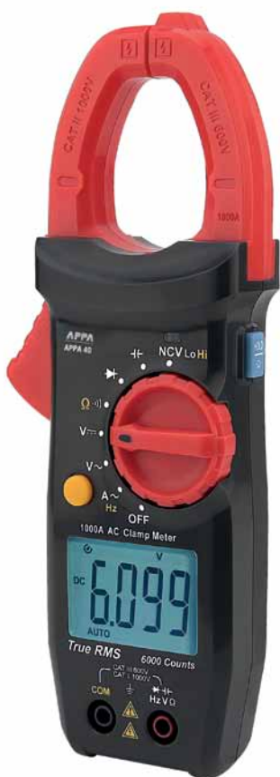
Рис. 2. Токовые клещи APPA 40
