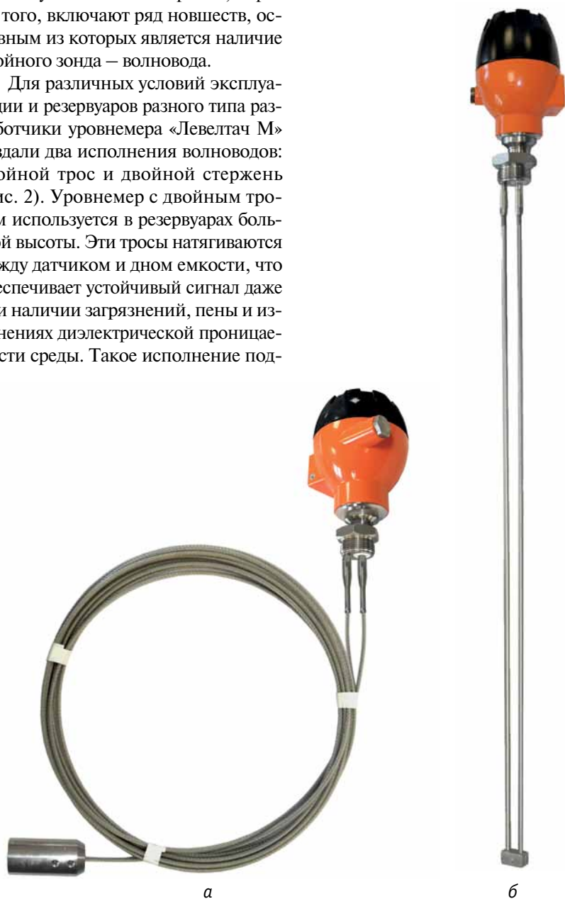
Рис. 2. Уровнемер «Левелтач М» с волноводами разного типа: а – двойной трос с грузом; б – двойной стержень
