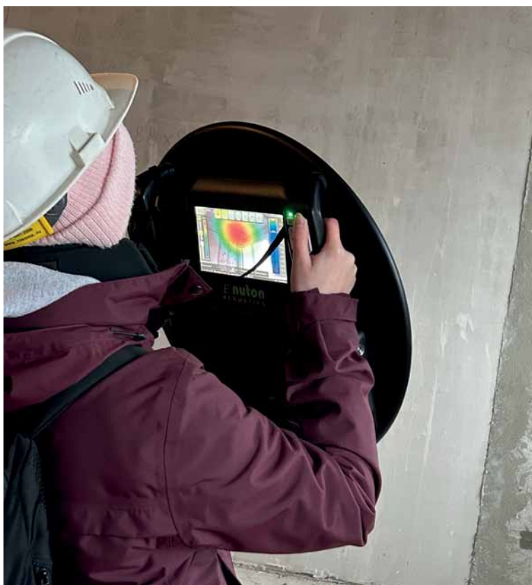
Рис. 3. Использование акустической решетки для локализации шума и оценки качества перекрытия
