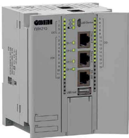
Рис. 3. Контроллер ОВЕН ПЛК210-14-CS управляет печью для обжарки орехов
