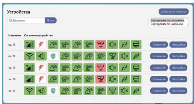
Рис. 6. Веб-приложение SmartSGK.ru: а – отображение состояния нескольких объектов в реальном времени; б – история уведомлений и аварий системы контроля загазованности
