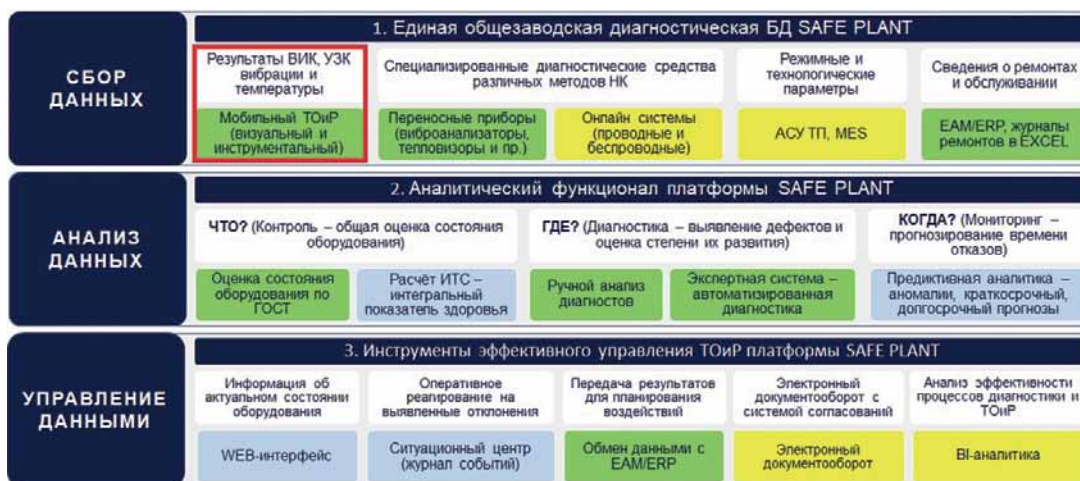
Рис. 4. Единая диагностическая система на базе платформы SAFE PLANT на предприятиях ПАО «ФосАгро»
