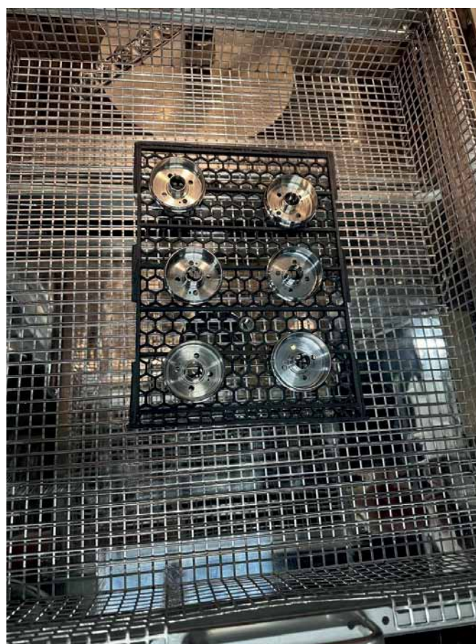
Рис. 3. Индивидуальная оснастка для крепления деталей, изготовленная для установки УСОТП-1
