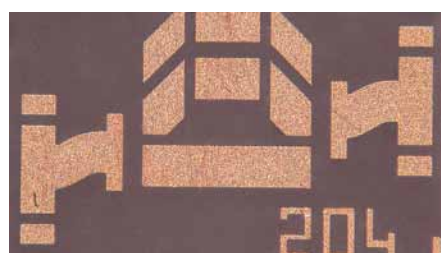
Рис. 5. Керамическая подложка полупроводникового кристалла под видеомикроскопом
