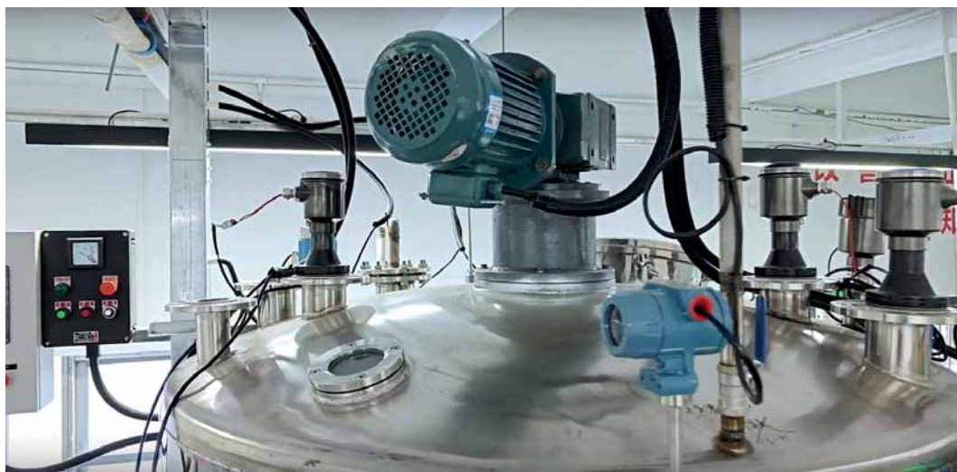
Рис. 5. Рефлекс-радарный уровнемер РИЗУР-2030 и установка гидравлических испытаний, имитирующая рабочую среду этих уровнемеров (видео ООО «НПО РИЗУР»)
