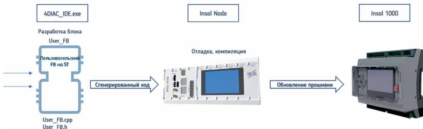
Рис. 15. Структура формирования, отладки и компиляции функциональных блоков
