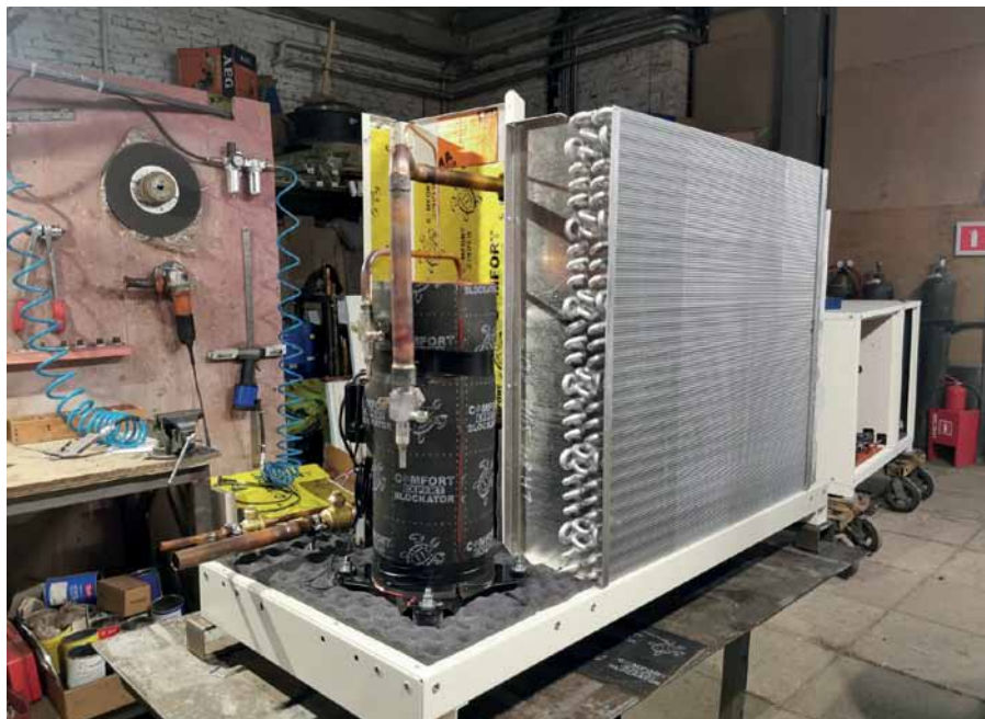
Рис. 4. Станция охлаждения «Мегахолод» с алюминиевым теплообменником
