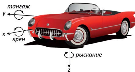
Рис. 9. Система координат автомобиля
