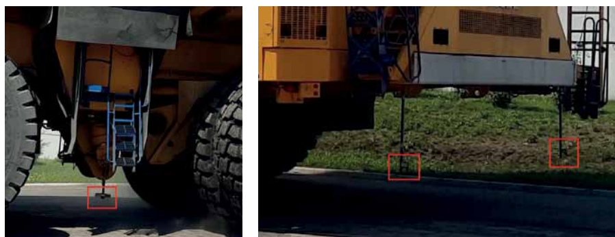
Рис. 10. Триангуляционные датчики, измеряющие расстояние до дорожного покрытия
