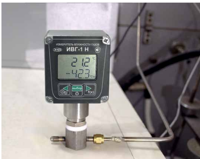
Рис. 2. Измеритель влажности газов ИВГ-1 Н-И с камерой проточного измерения
