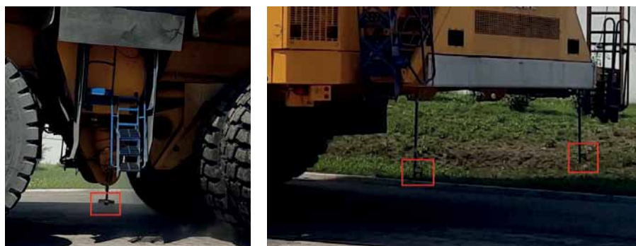
Рис. 10. Триангуляционные датчики, измеряющие расстояние до дорожного покрытия
