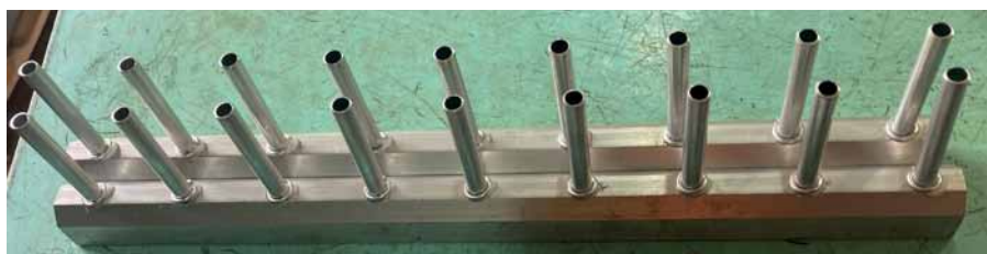
Рис. 3. Готовые тонкостенные алюминиевые трубы после пайки
