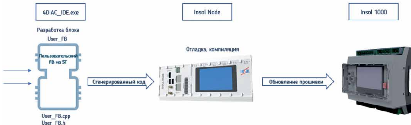
Рис. 15. Структура формирования, отладки и компиляции функциональных блоков
