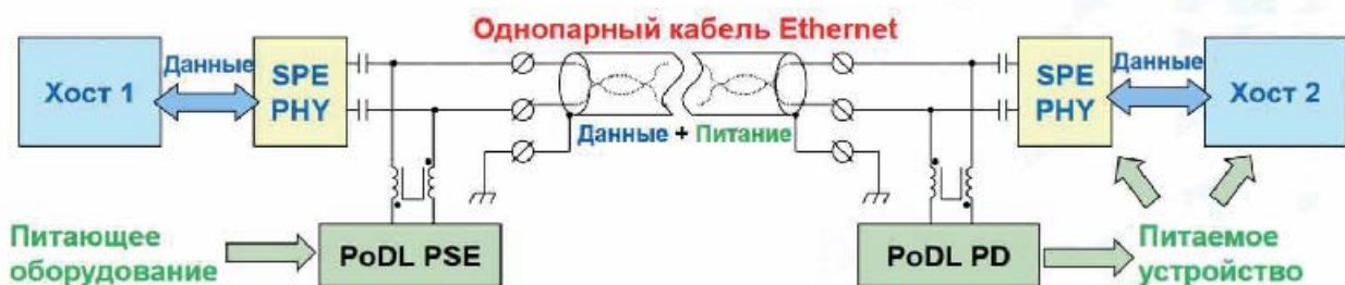
Рис. 1. Структурная схема стандарта Ethernet APL (источник – сайт компании Analog Devices)
