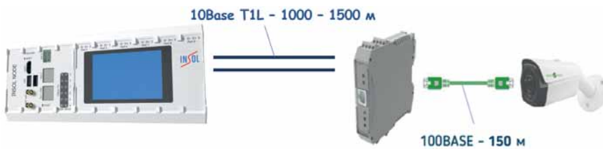
Рис. 8. Типовое решение для камер видеонаблюдения
