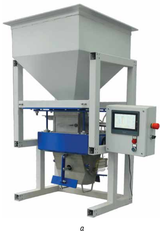
Рис. 2. Электронные дозаторы: а – бункерный для фасовки в открытые зашивные мешки; б – конвейерный для непрерывного дозирования и учета легкосыпучего продукта; в – ленточный непрерывного действия
