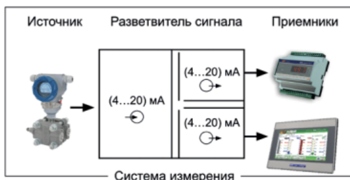
Рис. 6. Задача разветвления (размножения) сигналов
