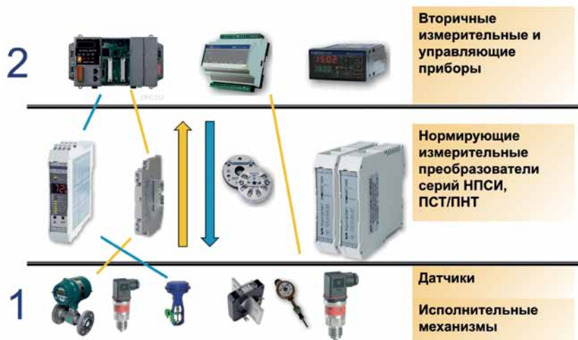
Рис. 1. Структура типовой системы автоматизации технологических процессов
