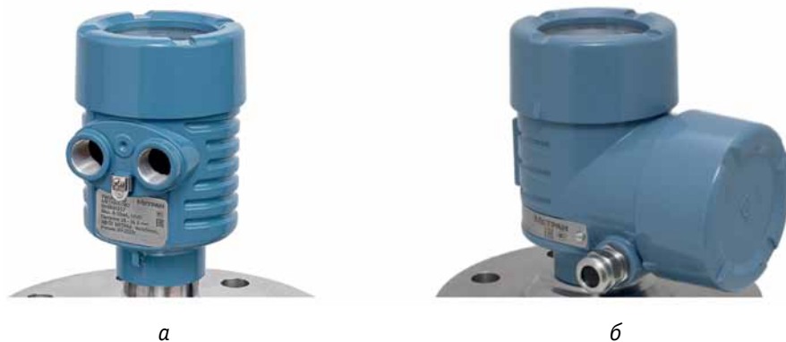
Рис. 3. Типы корпусов и виды взрывозащиты: а – односекционный корпус, исполнения общепромышленное и взрывозащищенное с видом взрывозащиты «искробезопасная цепь»; б – двухсекционный корпус, исполнения общепромышленное и взрывозащищенное с видами взрывозащиты «искробезопасная цепь», «взрывонепроницаемая оболочка», комбинированная взрывозащита
