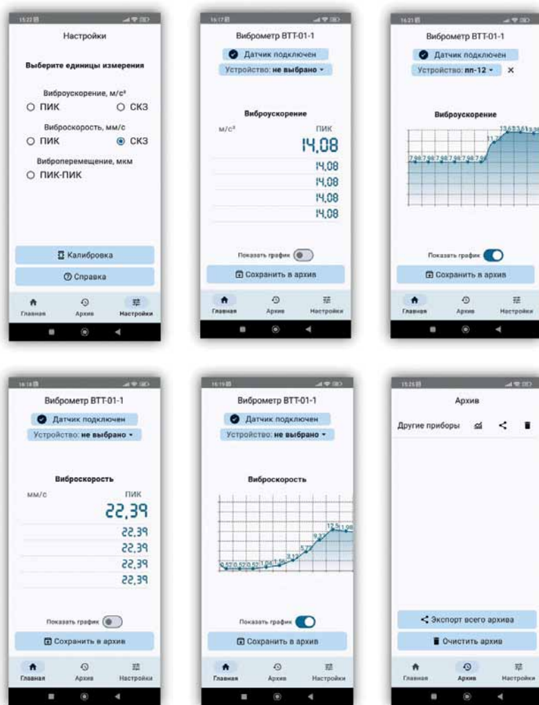
Рис. 3. Приложение «Виброметр ВТТ-01-1»: отображение данных
