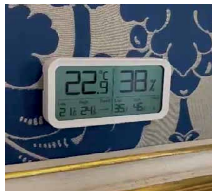
Рис. 3. Термогигрометр Ivit-2, установленный в залах дворцов Санкт-Петербурга
