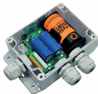
Рис. 4. Контроллер PROMODEM SV в автономном исполнении: удаленное или автоматическое управление клапанами и реле, питание от встроенной батареи с передачей состояния через встроенный GSM-модем
