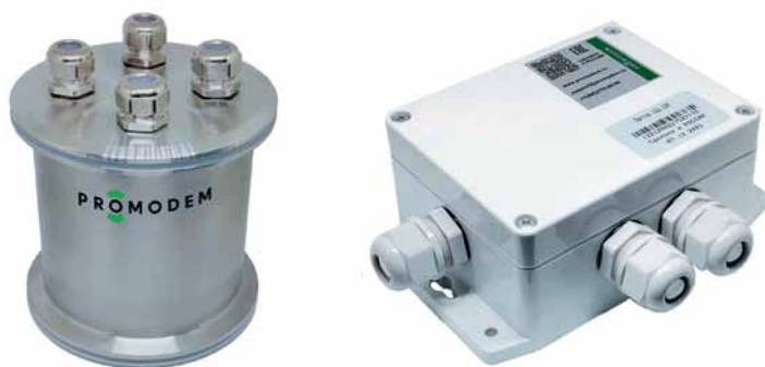
Рис. 2. Логгеры PROMODEM в металлическом или пластиковом корпусе, с универсальными входами (импульсные, аналоговые, RS-485), встроенным модемом GSM/LTE и питанием от сменной батареи, заряжаемого аккумулятора или от сети
