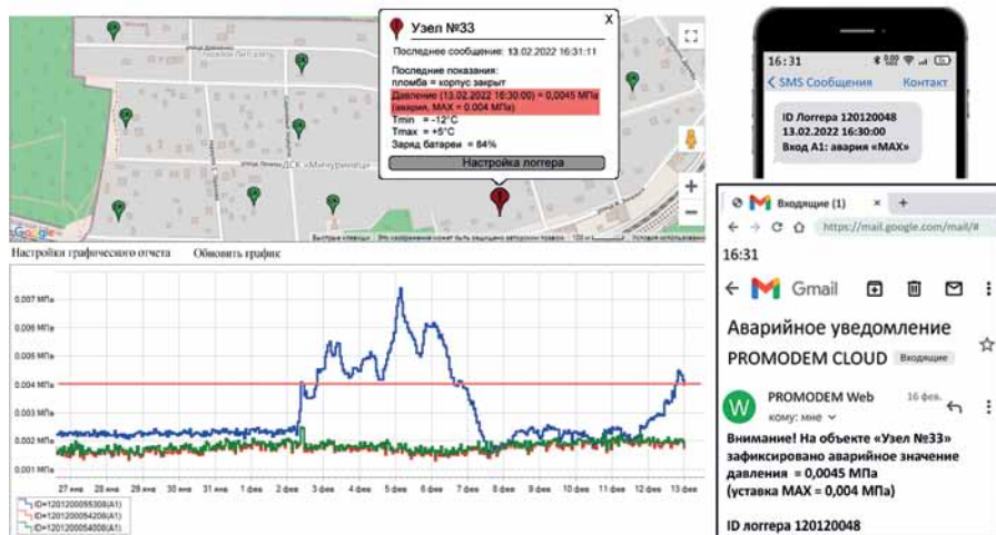
Рис. 6. Система диспетчеризации PROMODEM CLOUD. Извещения об аварийных событиях: слева – индикация на веб-карте; справа – примеры аварийных e-mail- и СМС-сообщений на телефоны сотрудников
