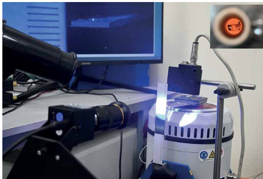
Рис. 3. Система оптического катетометра; справа сверху – пример размещения объекта в температурной камере
