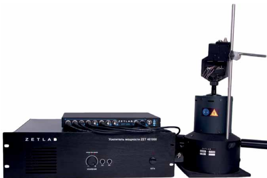
Рис. 1. Установка для усталостных испытаний турбинных лопаток на базе пьезокерамического вибростенда ZET 6150 (на рисунке – справа)
