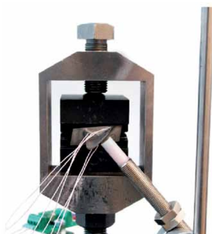
Рис. 2. Зажимное устройство испытательной установки
