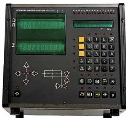
Рис. 1. Один из аналогов ОПУ LJUMO – отечественная система для токарных станков K525
