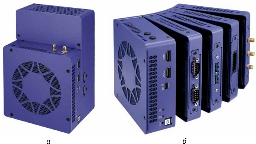
Рис. 1. Компьютеры серии Vecow TGS: а – ультракомпактная модель TGS-1550; б – исполнение из четырех блоков
