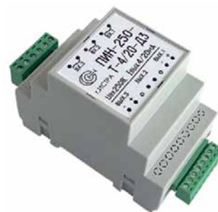
Рис. 7. Датчик ПИН-250-Т-4/20-Д3 для измерения 3-фазного напряжения до 400 В; True-RMS и возможность крепежа на DIN-рейку
