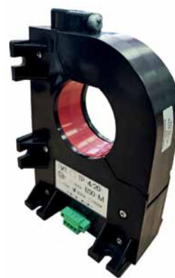
Рис. 5. Разъемные датчики тока, которые не требуют демонтажа токовой цепи и крепятся непосредственно на токовой шине: а – ПИТ-□-ТР-4/20-Б20x20 с отверстием под токовую шину 20 × 20 мм и диапазоном измерения тока 300 А; б – ПИТ-□-ТР-4/20-Б50-М для крепежа на шине диаметром до 50 мм, диапазон измерения 1000 А
