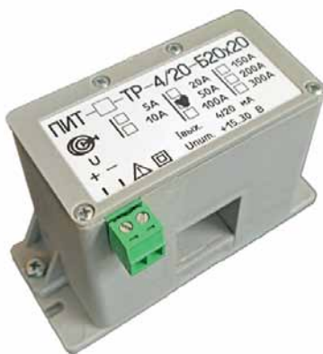
Рис. 5. Разъемные датчики тока, которые не требуют демонтажа токовой цепи и крепятся непосредственно на токовой шине: а – ПИТ-□-ТР-4/20-Б20x20 с отверстием под токовую шину 20 × 20 мм и диапазоном измерения тока 300 А; б – ПИТ-□-ТР-4/20-Б50-М для крепежа на шине диаметром до 50 мм, диапазон измерения 1000 А
