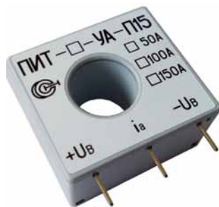
Рис. 2. Датчик тока ПИТ-□-УА-П15 для бесконтактного измерения тока до 150 А, с диаметром отверстия под токовую шину 15 мм
