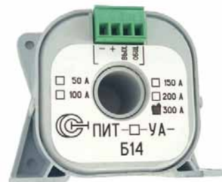
Рис. 3. Датчик тока ПИТ-□-УА-Б14 для измерения тока до 300 А, с диаметром отверстия под токовую шину 14 мм и возможностью крепления в блок с помощью DIN-рейки
