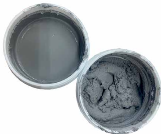
Рис. 2. Паяльная паста, перемешанная ручным способом ( слева ) и в миксере на протяжении 30 минут ( справа )
