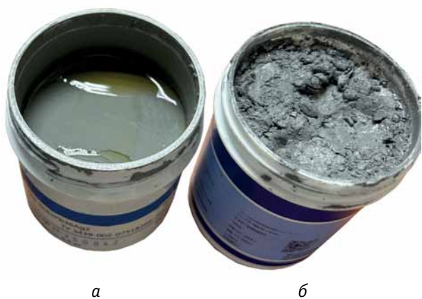
Рис. 1. Нагретая паяльная паста: а – нагрев выполнялся постепенно несколько часов до комнатной температуры; б – следствие локального перегрева
