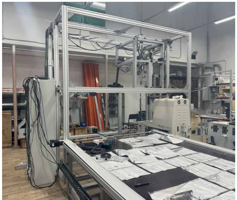
Рис. 2. Линия обработки провода в процессе сборки и станок для раскладки жгутов
