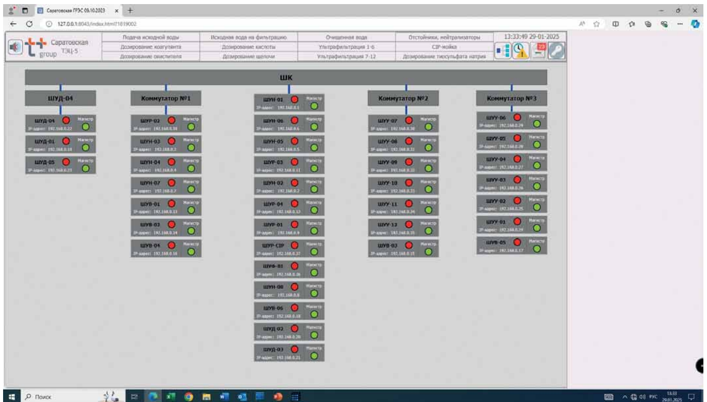
Рис. 4. Структура и состав технических средств АСУ ХВО Саратовской ТЭЦ-5
