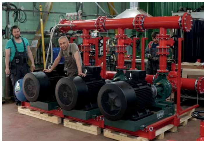
Рис. 5. Станция пожаротушения, изготовленная для военного объекта
