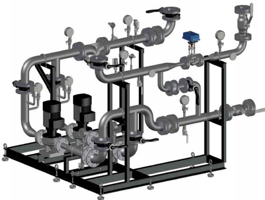
Рис. 3. Модуль вентиляции БТП: 3D-модель
