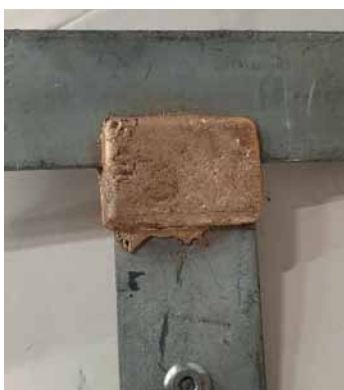
Рис. 2. Примеры соединений, выполненных по технологии термитной сварки
