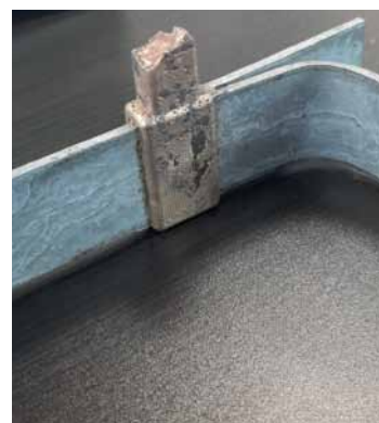
Рис. 2. Примеры соединений, выполненных по технологии термитной сварки
