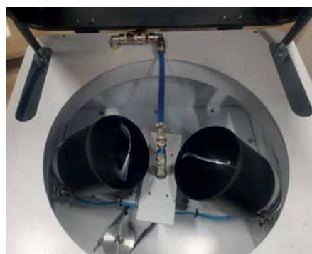
Рис. 4. Внутри миксера: два контейнера для материала и система вакуумирования (опция)
