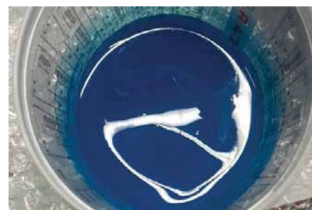
Рис. 6. Результат смешивания многокомпонентного материала на основе аэросила для пульпирования зубных каналов
