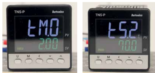
Настраиваем время и уставку для каждого шага. На фото показано время для 1-го шага, и уставка для 3-го шага
