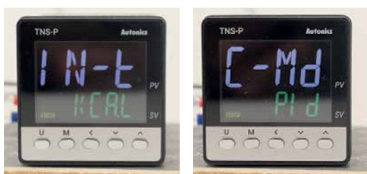
Устанавливаем тип входа, выбираем тип регулирования PID
