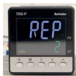
Производим тонкую настройку контроллера: устанавливаем количество повторений ранее введенной программы управления (pattern)
